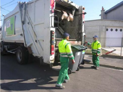
L'image ci-dessus et le schéma ci contre, représentent l'arrière d'un camion Jumbo utilisé pour le ramassage des ordures ménagères. Celui-ci est équipé d'un dispositif permettant la montée, puis le basculement de poubelles adaptées. Ce système mécanisé permet de déverser les ordures par la trappe du camion. Cette tâche, qui avant cette mécanisation fut assez pénible, se voit considérablement allégée.
