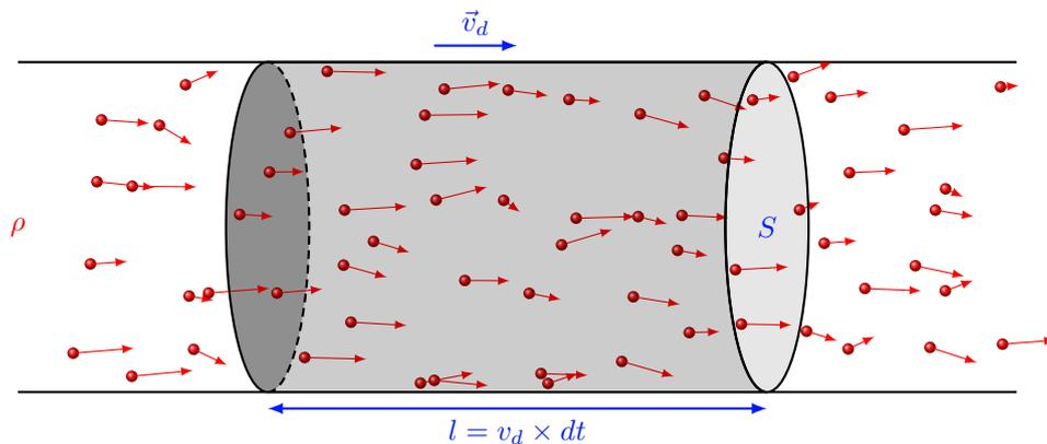
Le nombre de particules mobiles, de vitesse moyenne  $v_d$  qui passe à travers la surface  $S$  pendant  $dt$  est égal au nombre de particule qui se trouvent dans un cylindre de base  $S$  et de hauteur  $v_d \times dt$ , ici :  $dq = \rho \times (S \times v_d \times dt)$ .
