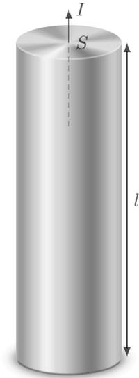
Si on s'intéresse au courant traversant un morceau de fil métallique, où règne un champ électrique imposé par une différence de potentiel  $|\Delta V|$ , on aura :
