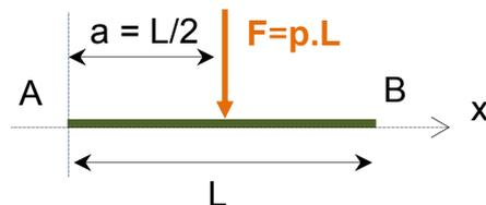
**Cas d'une charge linéique linéaire** (action fluide suivant la verticale, action de liaison excentrée)
