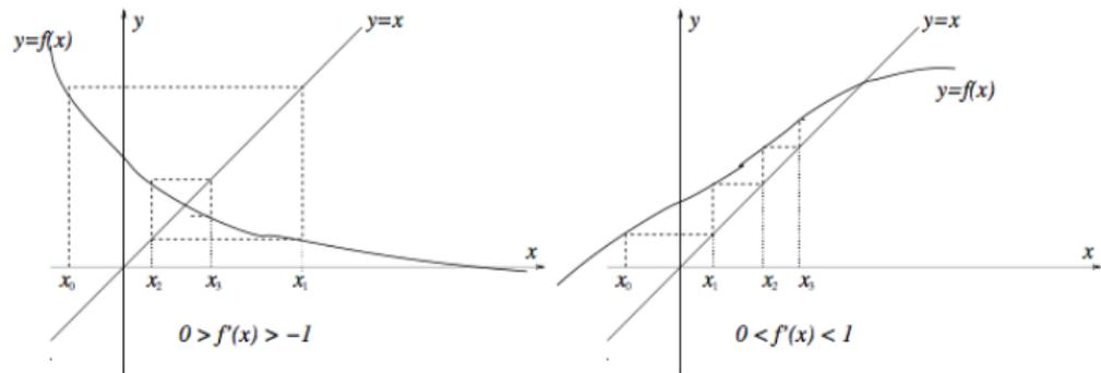
FIGURE 3.4 – Premiers itérés d'une méthode de point fixe.
