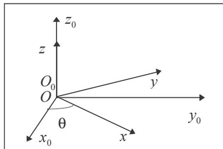
On démontre aisément le résultat important suivant : quand un solide  $S$  est en liaison pivot d'axe  $(O_0\vec{z}_0) = (O_S\vec{z}_S)$  et de paramètre  $\theta = (O_0\vec{x}_0, O_0\vec{x}_S)$  choisi direct par rapport à un solide de référence  $0$ , le vecteur instantané de rotation est :
