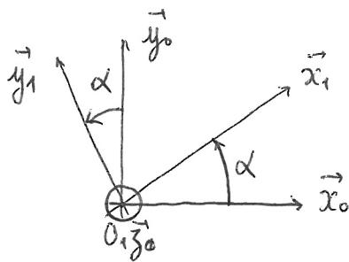
$$\vec{O_1 G_1} = X_{G_1} \vec{x}_1 + Z_{G_1} \vec{z}_1$$
