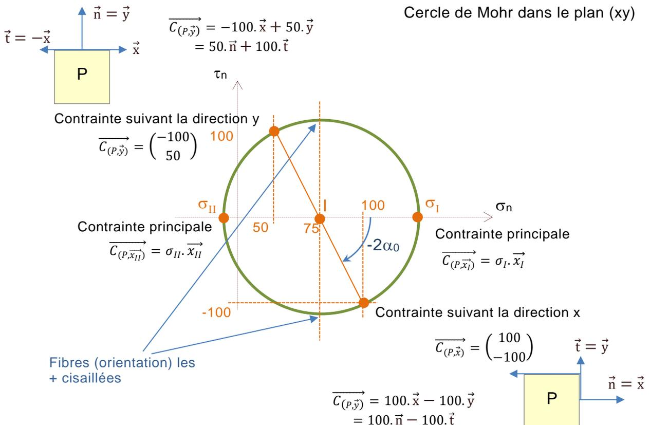
Etape 1 : on positionne les contraintes suivant x et suivant y (matrice des contraintes)
