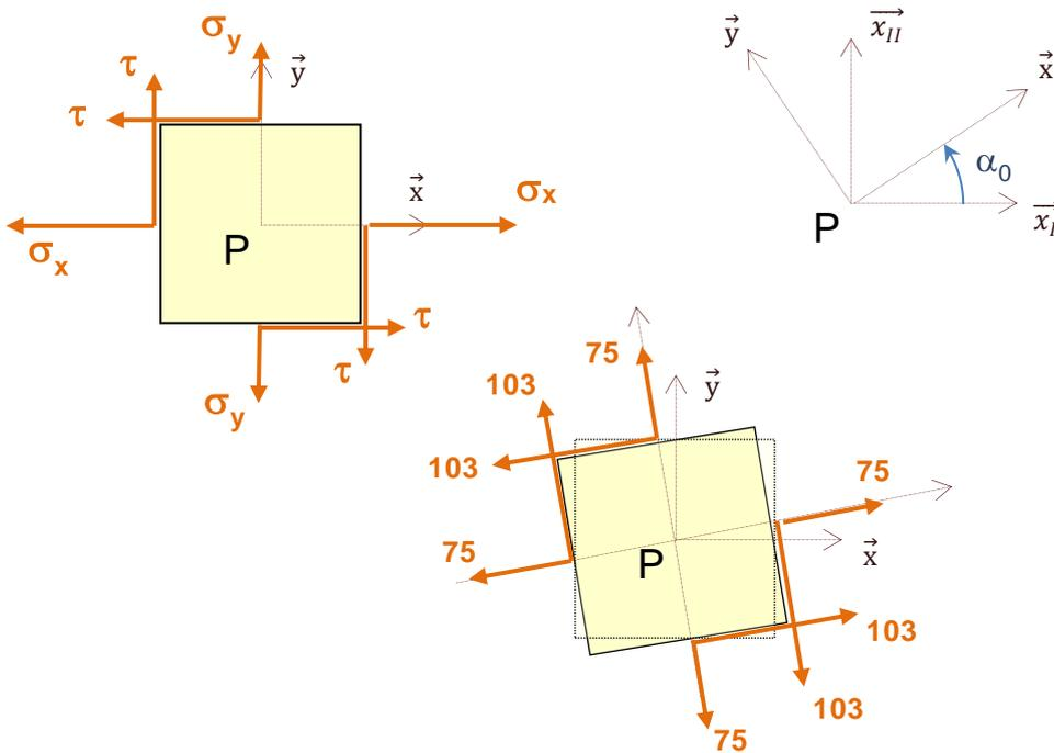
On calcule l'angle entre la direction principale  $\vec{x}_I$  et la direction  $\vec{x}$  :  $\text{tg}(-2\alpha_0) = -100/25 = -4$  d'où  $\alpha_0 = 38^\circ$
