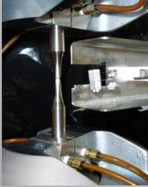
Eprouvette en cours d'essai
