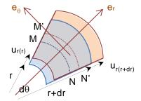
On voit que le petit élément en coordonnées cylindriques à une déformation
